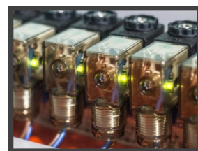
Conector eléctrico con led indicador.
